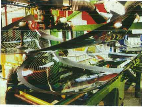
جانب من مصنع زجاج السيارات، تبدو فيه التقنية الصناعية لثني الزجاج
